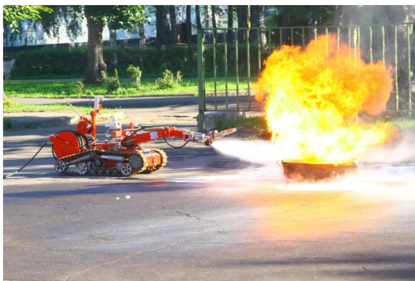
Рисунок 76. Тушение очага пожара роботом МРК-РП
